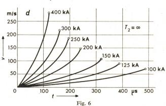
Geschwindigkeit v stromdurchflossener Drähte durch den Blitzstrom Drahtquerschnitt 20 mm², Achsabstand 30 mm
