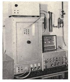
Luftverschmutzungen noch Konzentrationsunterschiede für Einzelkomponenten in einer Grössenordnung von  $10^{-2}$  mg/m³ messtechnisch exakt nachweisen. Die Messeinrichtung besteht aus einem Gas-Chromatograph L 150 und einem darüber angeordneten Speicherdosieraggregat sowie einem Stromversorgungsteil mit Programmgeber.
