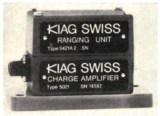
Messwertaufnehmer abgegebene elektrische Ladungssignal in eine proportionale Spannung umwandelt. Der extrem hohe Eingangswiderstand wird durch einen J-FET in der Eingangsstufe erreicht. Der stufenlos (Bereich 1:10) einstellbare Messbereich (Empfindlichkeit) kann durch einfaches Aufschrauben von Bereichszusätzen ganz wesentlich erweitert werden.
