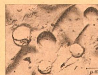
Fig. 3 Trübgas aus einem Triplex-Opal-Beleuchtungskörper mit vorteilhafter Teilchengrösse, Form und Zahl. Elektronenmikroskopische Aufnahme nach dem Abdruckverfahren Merkmale siehe Tabelle I
