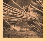
serlängsachsen streuen. Ausserdem können die in diesem Werkstoff eingebauten Glasfasern, falls sie von einer Oberfläche zur anderen (auch unter verschiedenen Winkeln) führen, die Rolle eines Faserlichtleiters annehmen.
