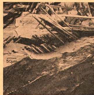
Fig. 10 Glasfaserverstärkter Kunststoff. Electro-Scan-mikroskopische Aufnahme
