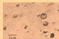
Fig. 2 Trübgas mit tröpfchenförmigen Entmischungsbezirken. Rechts im Bilde Verbindung zweier benachbarter Teilchen zu einem grösseren. Elektronenmikroskopische Aufnahme nach dem Abdruckverfahren Merkmale siehe Tabelle I
