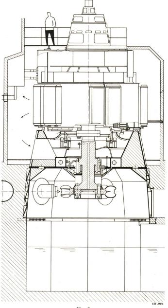
Fig. 2 Vertikalschnitt der Turbinen-Generator-Gruppe der Zentrale La Bâtiaz
