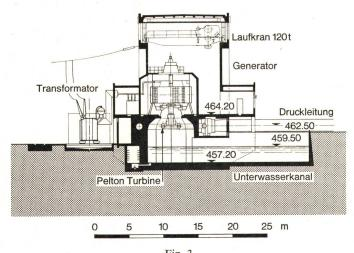
Fig. 3 Dispositionsplan der Zentrale La Bâtiaz
