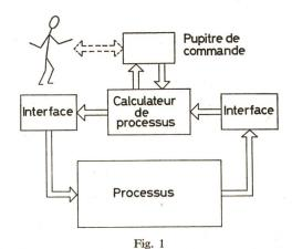
Disposition de principe d'un calculateur de processus (Hardware)
