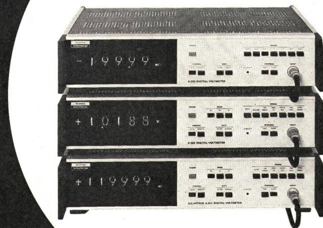
Die Digitalvoltmeter der «Master-Serie» gibt es jetzt in siebzehn Varianten für DC-, AC-, OHM- oder Ratio-messungen, auch für System-einbau mit 25 oder 100 Messungen/Sekunde
