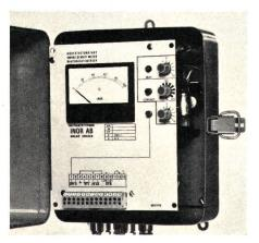
Meßsonden. Zur Fernübertragung und Registrierung des Messwertes ist ein eingeprägter Ausgangsstrom vorhanden.
