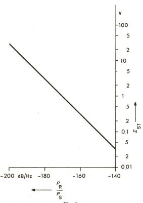
$\begin{array}{c} {\rm Fig.~6} \\ {\rm Zusammenhang~zwischen~zul\ddot{a}ssiger~St\ddot{o}r\text{-EMK}~E_{ST}} \\ {\rm und~Senderrauschabstand~} P_{\rm R}/P_{\rm S} \end{array}$
