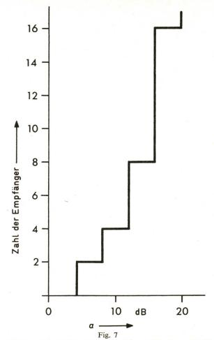
Anzahl der an einen passiven Antennenverteiler anschliessbaren Empfänger bei gegebener Vorschaltdämpfung a
