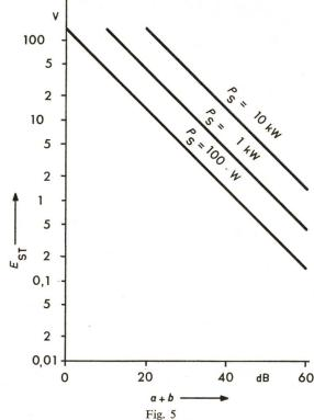
Stör-EMK  $E_{\rm ST}$  am Empfänger-Eingang für  $R_{\rm i}=50~\Omega$
