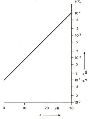
Fig. 3 Vorschaltdämpfung a für Anpassung der äusseren Störleistung  $P_{\rm A}$  bzw. des Senderrauschens an der Empfangsantenne  $P_{\rm RE}$  an Empfänger mit 10  $kT_0$   $kT_0$  Empfängerrauschzahl
