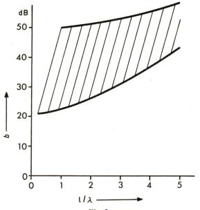
Fig. 2 Antennenentkopplung zwischen vertikalen, bedämpften KW-Antennen eines Antennenfeldes
