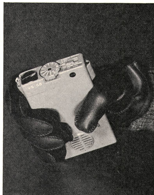
Fig. 1 Ein Verschütteten-Suchgerät nach dem Sender-Empfänger-Prinzip
