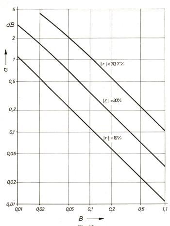
Fig. 12 Dämpfung a durch Verluste des Parallelschwingkreises bei der Resonanzfrequenz, abhängig von der relativen Bandbreite  $\boldsymbol{B}$
