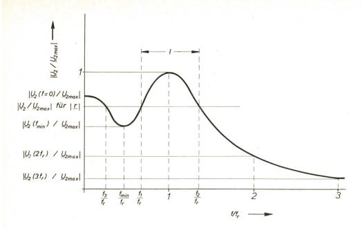
Fig. 4 Die Spannungsübertragungsfunktion des π 1-Resonanztransformators in Abhängigkeit von der normierten Frequenz
