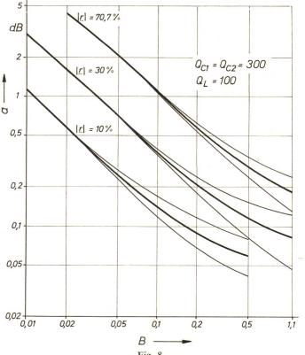
Fig. 8 Wie Fig. 7, aber die Kurven sind errechnet für die Bauelementegüten  $Q_{\rm C1}=Q_{\rm C2}=300,\,Q_{\rm L}=100$
