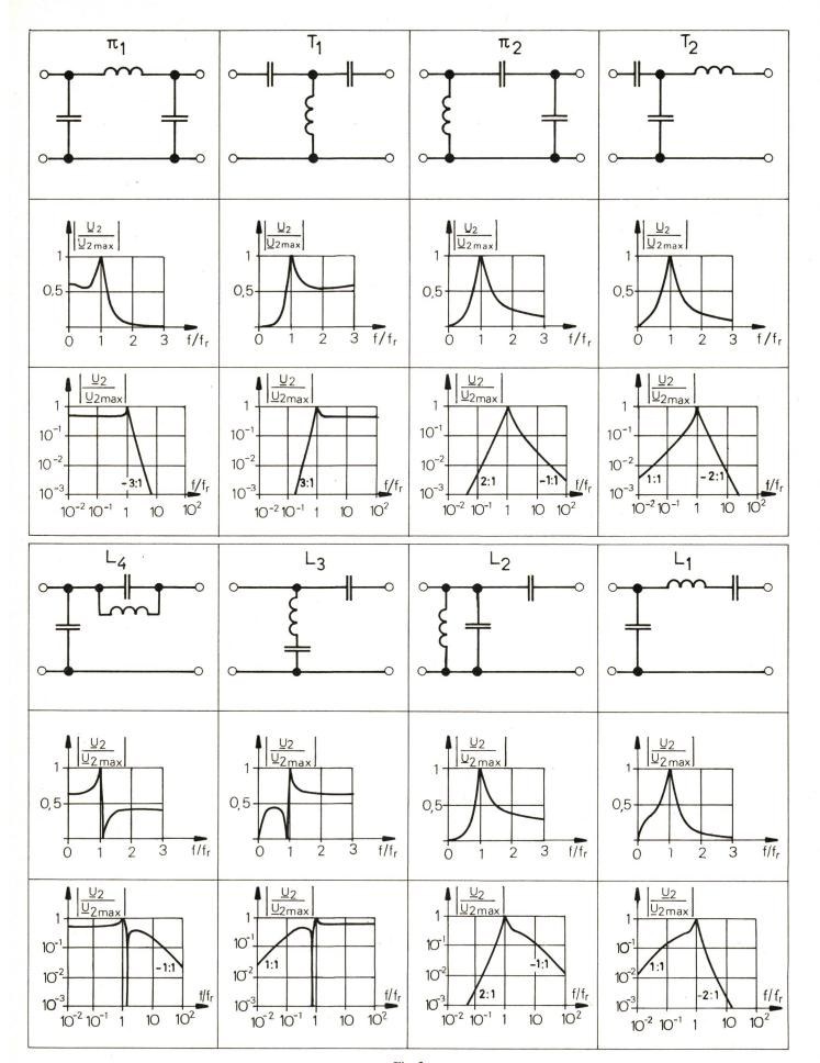
$Fig.\ 2$  Das Übertragungsverhalten der acht Resonanztransformatoren in linearer und doppellogarithmischer Darstellung
