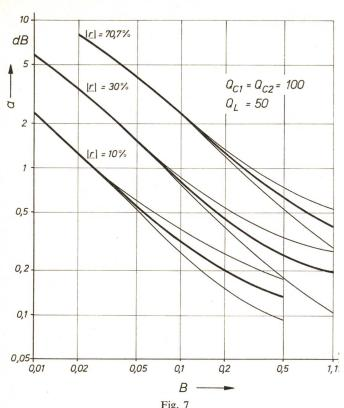
Zusatzdämpfung a der Resonanztransformatoren, abhängig von der relativen Bandbreite B bei der Resonanzfrequenz
