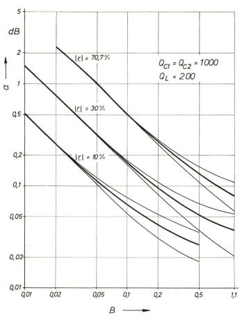
Fig. 9 Wie Fig. 7, aber die Kurven sind errechnet für die Bauelementegüten  $Q_{\rm C1}=Q_{\rm C2}=1000,\,Q_{\rm L}=200$
