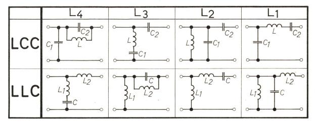
${\bf Fig.~3}$  Schemata der acht LCC- und dazu dualen LLC-Resonanztransformatoren
