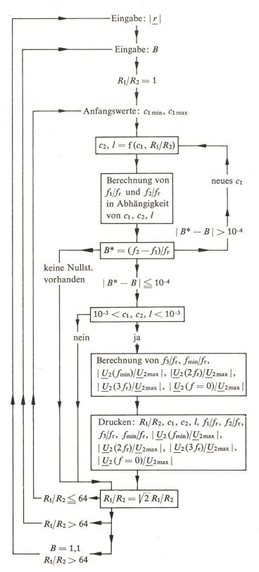
$Fig. \ 5 \\ \textbf{Das Signalflussdiagramm des Rechenprogramms für den} \\ \pi \ 1\text{-}\textbf{Resonanztransformator}$
