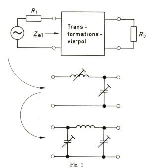
Beispiel für einen Transformations-Vierpol zur Anpassung von  $R_2$  an  $R_1$  mit zwei oder drei Reaktanzen Bei Anpassung ist  $Z_{\rm el}=R_1$  für die Resonanzfrequenz  $f_{\rm r}$
