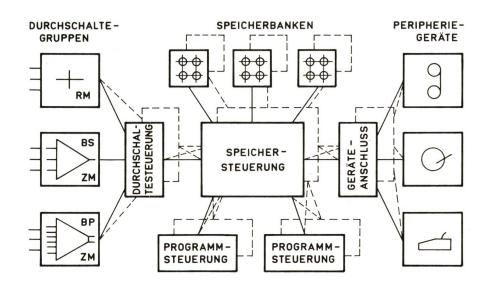
Fig. 1 EDS-Systemstruktur
