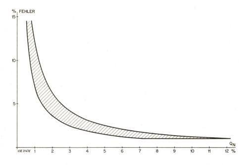
Fig. 13 Kurvenband für die Fehlergrenzen der verschiedenen Druckrohre
