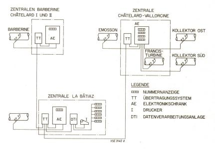
Fig. 5 Wassermengen-Messeinrichtungen von Emosson
