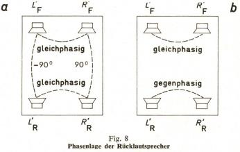
Phasenlage der Rücklautsprecher mit (a) und ohne (b) 90°-Phasenschieber
