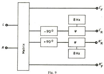
Matrix-Schaltung mit Phasenschieber und Phasenmodulator  $\varphi$  Phasenmodulator
