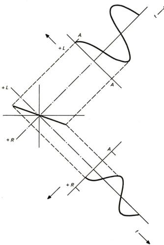
Fig. 18 Bewegung des Schneidstichels bzw. der Abtastnadel in der Schallplattenrille für ein gegebenes Beispiel
