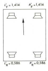
Beispiel 3: Mit Hilfe einer speziellen Aufnahmetechnik, wie sie z.B. bei der Aufnahme von Applaus auf «Live»-Schallplatten angewendet wird, herrsche im L-Kanal die Spannung L = 1, im rechten Kanal dagegen die Spannung R = -1 (!). Die Beträge in den beiden Kanälen sind zwar gleich gross, der Winkel zwischen beiden Spannungen betrage aber 180°. Gefragt ist nach den vier Lautsprechersignalen.
