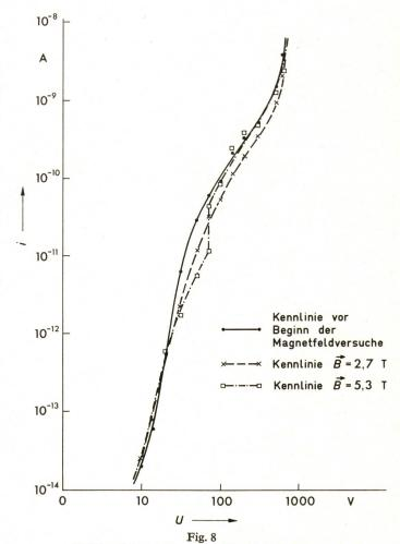
U-i-Kennlinien eines ZnS-Kristalls mit In-Elektroden
