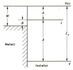
Fig. 4 Kontaktschema Metall/Isolator ohne Bandverbiegung für thermische Injektion
