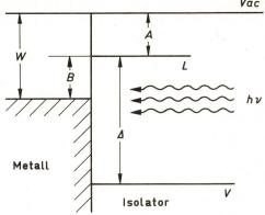
Fig. 6 Kontaktschema Metall/Isolator für Photoinjektion  $h \ v \ge B$  $\Delta - B \ge h v$
