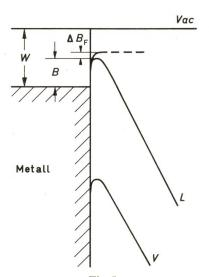
Fig. 5 Kontaktschema Metall/Isolator bei angelegter Spannung für felderleichterte thermische Injektion (Schottkyinjektion) △ B<sub>F</sub> Potentialschwellenerniedrigung
