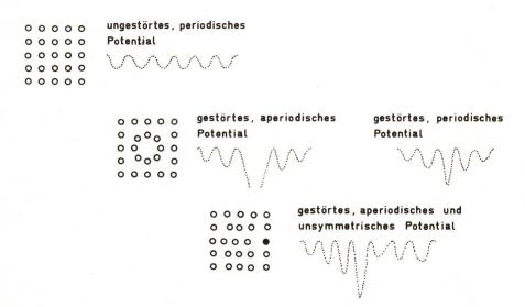
Fig. 7 Modell für Gitterstörungen und Potentiale
