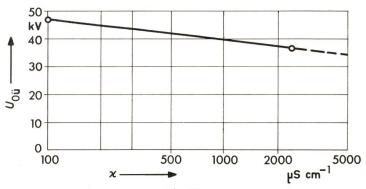
Fig. 13 Einfluss der Leitfähigkeit  $\kappa$  auf die Überschlagspannung  $U_{0ii}$   $M=0{,}32~{\rm ml};~Z_i=107~{\rm k}\Omega$  M Belagmenge;  $Z_i$  Netzimpedanz
