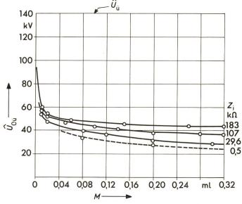
Fig. 7 Überschlagspannung  $\mathcal{D}_{0ii}$ , abhängig von der Belagmenge M bei verschiedenen Netzinnenimpedanzen  $Z_{\hat{1}}$   $\kappa=2500~\mu\mathrm{S~cm^{-1}}$
