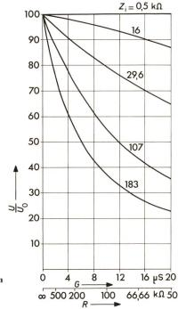
Bezogene Spannung  $U/U_0$ , abhängig vom Leitwert G der Belastung bei verschiedenen Netzinnenimpedanzen  $Z_1$   $U_0=10~\mathrm{kV}$
