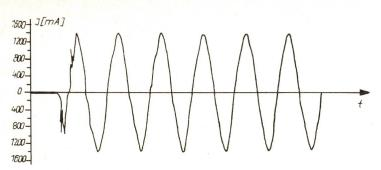
Fig. 19 Fremdschichtüberschlag bei Zuschaltüberspannung  $Z_1 = 29.6 \text{ k}\Omega$ ; M = 0.12 ml;  $\hat{U}_0 = 43 \text{ kV}$
