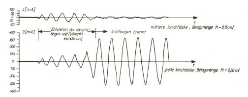
Die Elektrodenspannung bricht dann auf die Lichtbogenspannung zusammen.
