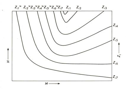
Fig. 23 Schematische Darstellung des Einflusses der Innenimpedanz des Speisenetzes auf die Überschlagzeit bei konstanter Zuschaltspannung Bezeichnungen siehe Fig. 14
