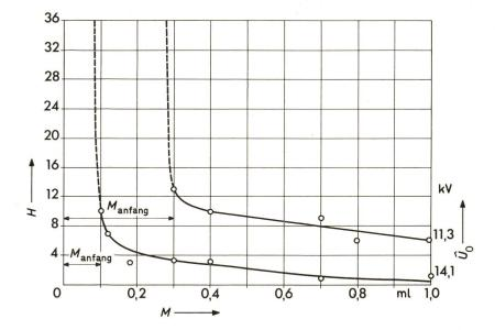
Zuschaltspannung, so wird das Minimum der Überschlagzeitkurven abhängig von der Belagmenge mit abnehmender Innenimpedanz des Speisenetzes immer breiter werden und tiefer sinken (Fig. 23). Dabei nehmen die Anfangsbelagmenge sowie die Überschlagzeit ab und der rechte Ast verläuft immer flacher. Schliesslich steigt die Überschlagzeit im Gebiet grosser Belagmenge nicht mehr an.
