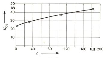
Fig. 12 Einfluss der Netzinnenimpedanz  $Z_{\rm i}$  auf die Überschlagspannung  $\vartheta_{0\ddot{\rm u}}$  M=0,32 ml;  $\kappa=2500~\mu{\rm S~cm^{-1}}$  M Belagmenge;  $\kappa$  Leitfähigkeit
