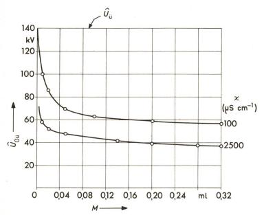
Fig. 9 Überschlagspannung  $\mathcal{O}_{0\ddot{u}}$  in Abhängigkeit von der Belagmenge M bei verschiedenen Leitfähigkeiten  $\kappa$  der Fremdschicht  $Z_i = 107~\mathrm{k}\Omega$
