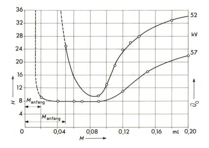
Fig. 14 Überschlagzeit H (in Anzahl Halbwellen), abhängig von der Belagmenge M bei verschiedenen Spannungen  $Z_i = 183~\mathrm{k}\Omega$   $\mathcal{O}_0~\mathrm{Spannung};~Z_i~\mathrm{Impedanz}$
