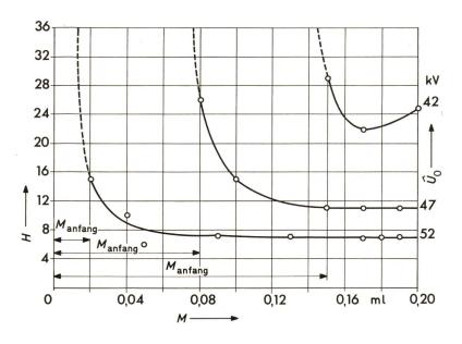
Überschlagzeit H (in Anzahl Halbwellen), abhängig von der Belagmenge M bei verschiedenen Spannungen  $Z_{\rm i} = 107 \text{ k}\Omega$ Weitere Bezeichnungen siehe Fig. 14
