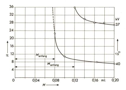
Fig. 18 Überschlagzeit H (in Anzahl Halbwellen), abhängig von der Belagmenge M bei verschiedenen Spannungen  $Z_1=29.6~\mathrm{k}\,\Omega$
