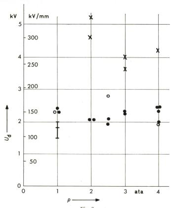
Fig. 9 Durchschlagspannung  $U_{\rm d}$  bei 0 und 50 Hz in Abhängigkeit von Druck p bei 1 Lage Polypropylen 15,2
