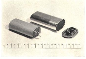
Fig. 4 Versuchskondensator
