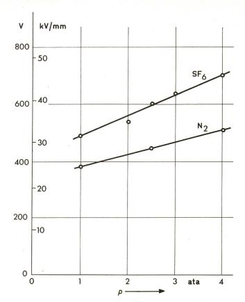
Fig. 6 TE-Einsatz in Abhängigkeit vom Druck p für SF $_6$  und  $\mathbf{N}_2$ bei Raumtemperatur
