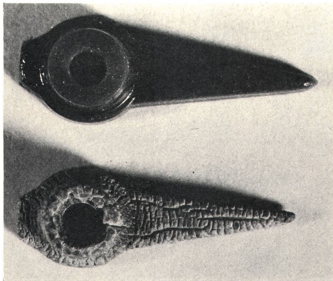
Fig. 6 Geschrumpfte Polyacetal-Zeiger nach mehrjähriger, intensiver Wärme-Licht-Einwirkung (vgl. Fig. 1)
