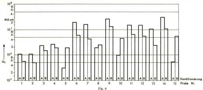
Einfluss der Luftfeuchtigkeit und Alterung auf den spezifischen Durchgangs- (Volumen-) Widerstand Q
