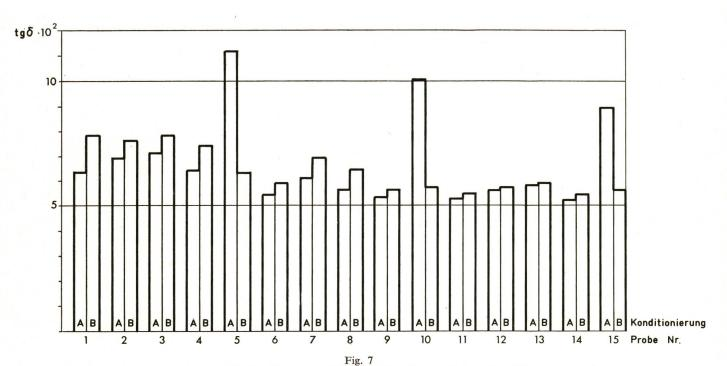
Einfluss der Luftfeuchtigkeit und Alterung auf den Verlustwinkel tg  $\delta$  bei 100 Hz
