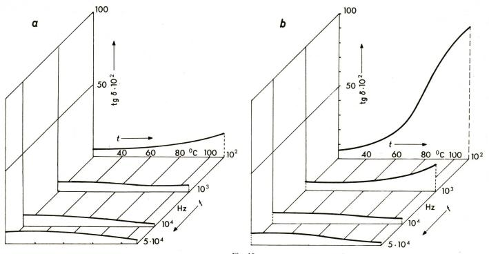
Fig. 10 Temperatur- (t) und Frequenzabhängigkeit (f) des Verlustwinkels ( $tg \delta$ ) von PVC mit verschiedenen Stabilisatoren
