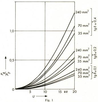
Verhältnis der dielektrischen  $(P_{cl})$  zur Jouleschen  $P_{\varrho}$  Verlustleistung in einem Drehstromkabel in Abhängigkeit von der Betriebsspannung U (tg  $\delta$  bei 50 Hz und Leiterquerschnitt als Parameter)
