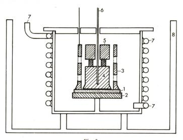
Fig. 3 Messeinrichtung für temperaturabhängige Messungen im Schnitt
