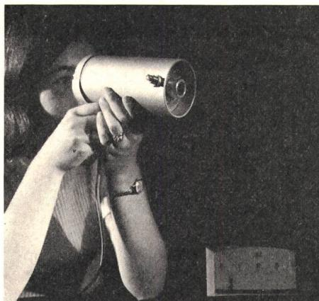
peraturen im Bereich von 0 bis 800 °C berührungslos gemessen werden, wobei das Temperaturfeld des Messobjektes nicht beeinflusst wird. Das Gerät arbeitet verschleissfrei mit einer Einstellzeit von etwa einer Sekunde. Ausgangssignal ist ein eingeprägter Gleichstrom von 0 bis 20 mA bzw. bei unterdrücktem Nullpunkt von 4 mA bis 20 mA.
