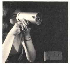
peraturen im Bereich von 0 bis 800 °C berührungslos gemessen werden, wobei das Temperaturfeld des Messobjektes nicht beeinflusst wird. Das Gerät arbeitet verschleissfrei mit einer Einstellzeit von etwa einer Sekunde. Ausgangssignal ist ein eingeprägter Gleichstrom von 0 bis 20 mA bzw. bei unterdrücktem Nullpunkt von 4 mA bis 20 mA.
