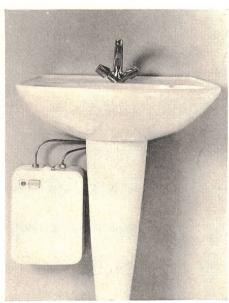
mindert Kesselsteinbildung. Sollte die Wassertemperatur unter 5 °C sinken, schützt Frostschutzautomatik das Gerät vor Frost. Überhitzen wird durch Trockengehschutz verhindert. Heizung 2 kW / Aufheizzeit auf 85 °C: 15 min.
