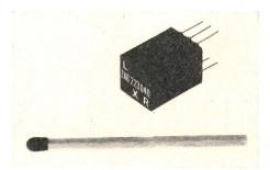
kung sowie durch kleine Dimensionen aus. Der Mischer kann an den *L*- und *R*-Eingängen zwischen 65 kHz und 350 MHz und am *X*-Eingang zwischen 0 und 350 MHz verwendet werden. Die Mischdämpfung beträgt typisch 6 dB. Dank besonderen Konstruktionsmassnahmen ist eine Trägerunterdrückung von mehr als 60 dB bei 1 MHz oder mehr als 40 dB bei 100 MHz erzielt worden.
