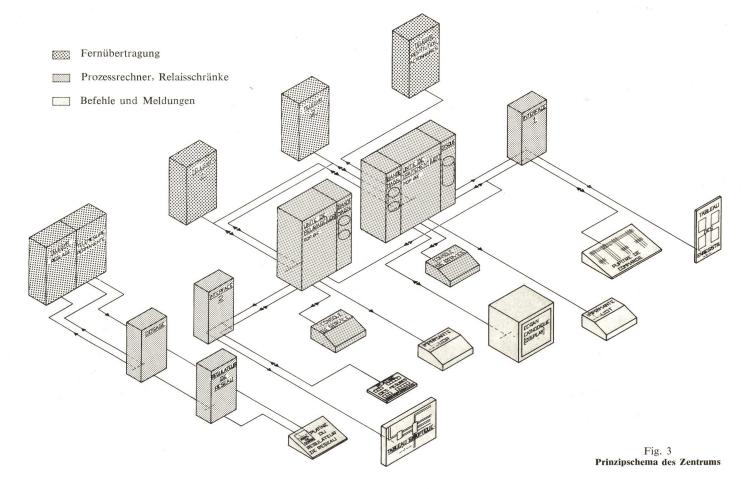
einem Kathodenstrahl-Bildschirm, Display genannt, verbunden, der die farbige graphische Darstellung des Schaltzustandes jeder Anlage mit gleichzeitiger Angabe von Momentanmesswerten ermöglicht.
