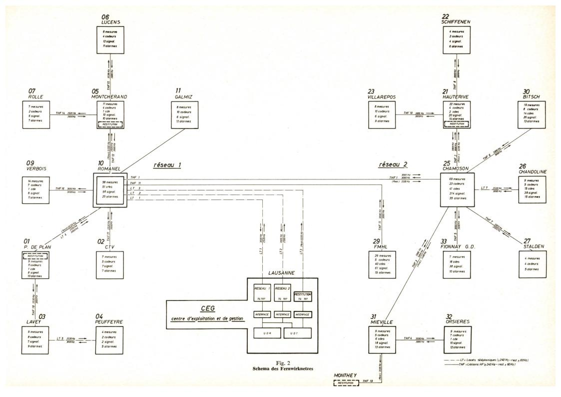
Abrechnung des Energieaustausches zwischen der EOS und seinen Aktionären gestattet. Dieses System erlaubt unter anderem, die Überwachung der bezogenen oder abgegebenen Energie.
