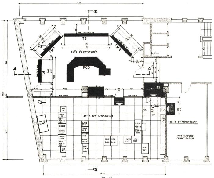
Fig. 10 Disposition des Kommando- und des Computerraums
