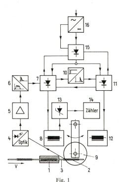
Blockschaltung der thyristorgesteuerten Schneidvorrichtung
