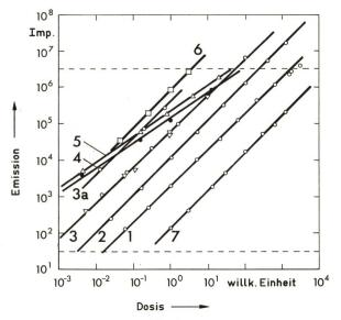
Fig. 8 Exoelektronen-Emission von Mischungen aus CaSO4 mit Graphit als Funktion der Ionendosis von Röntgenstrahlen [25]
