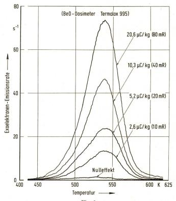
Fig. 6 Ausheizkurven einer BeO-Keramik-Probe bei verschiedenen Ionendosen ( $\gamma$ -Strahlen des  $^{60}$ Co)
