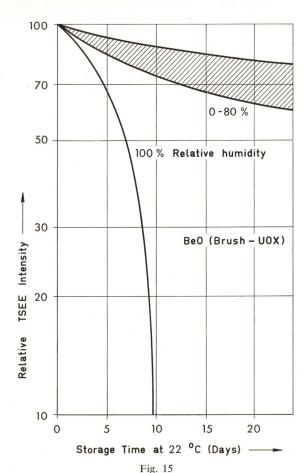
Fading der Exoelektronen-Emission von Proben aus BeO-Pulver mit Graphit auf Graphit-Trägern bei verschiedenen Luftfeuchtigkeiten bei 22 °C [28]
