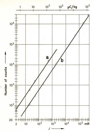
Fig. 5 Exoelektronen-Emission in Abhängigkeit von der Ionendosis J
