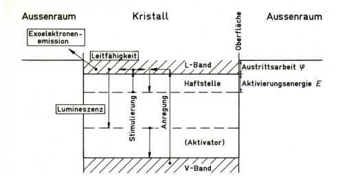
Fig. 1 Niveauschema für das Auftreten von elektrischer Leitfähigkeit, Lumineszenz und Exoelektronen-Emission [11]
