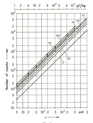
Fig. 9 Exoelektronen-Emission von Mischungen aus BeO-Pulver mit Graphit als Funktion der Ionendosis J von y-Strahlen des 60Co Parameter ist der BeO-Massenanteil in Prozent [32]
