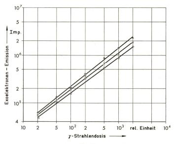
Fig. 11 Exoelektronen-Emission von BeO-Keramik als Funktion der Ionendosis von  $\gamma$ -Strahlen bei verschiedenen Aufheizgeschwindigkeiten [37]
