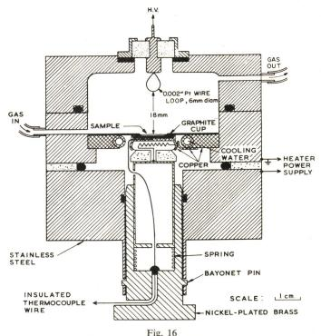
Schematische Darstellung eines Gasdurchfluss-Proportionalzählers für den Nachweis von Exoelektronen [50]
