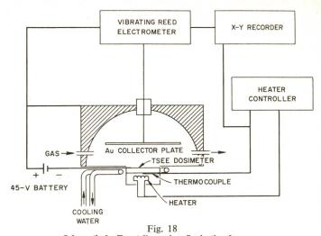
Schematische Darstellung einer Ionisationskammer
