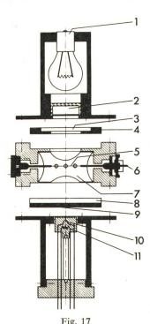
Schematische Darstellung eines Proportionalzählers für den Nachweis von Exoelektronen mit thermischer oder optischer Stimulierungsmöglichkeit der Proben
