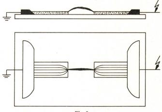
Fig. 9 Vorlichtbogen mit beiden Fusspunkten auf den Fremdschichtbelägen
