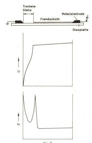
Fig. 7 Schematische Darstellung der Spannungs- und Feldstärkeverteilung der Prüfanordnung beim Auftreten einer trockenen Stelle im Fremdschichtbelag
