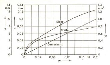
Fig. 3 Geometrie des Streifenbelages abhängig von der Belagmenge m
