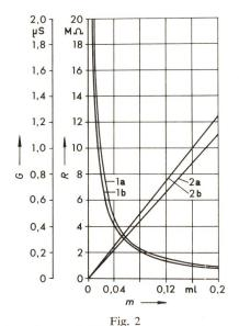
Belagleitwert G und Belagwiderstand R abhängig von der Belagmenge m Elektrodenabstand 20 cm; Belagleitfähigkeit 2500 μS/cm; Belagtemperatur 20 °C
