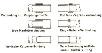
Fig. 25 Formgebung von Werkstücken für Kurzzeit-Induktionsverschweissung Die Schmelzzone ist schwarz
