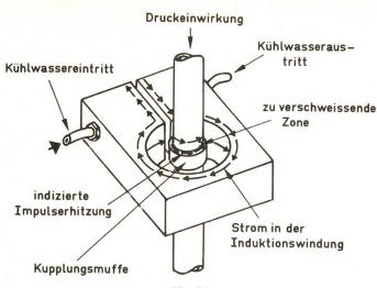
Fig. 24 Druckeinwirkung in Pfeilrichtung oben und induktive Impulserhitzung am Beispiel einer Verschweissung von Rohr mit Muffe
