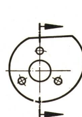
Fig. 9 Empfehlenswerte Formgebungen für Ultrapulsschweißlinge mittels Drehautomaten oder Stanzen herstellbar
