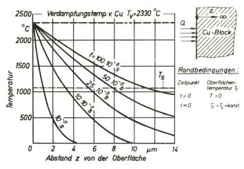
Fig. 20 Temperaturausgleich in einem einseitig unendlich ausgedehnten Kupferkörper nach Visser
