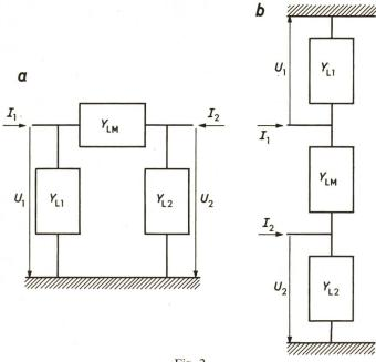
Fig. 2 Schéma équivalent d'un système général de terminaisons
