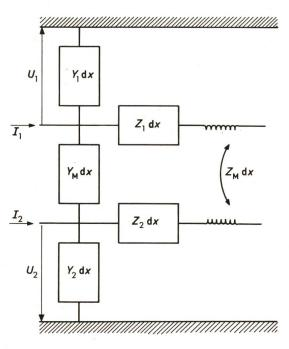
Fig. 1 Schéma électrique équivalent d'une longueur infinitésimale d de lignes couplées
