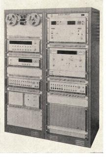
neren Prüffeldern. In Verbindung mit dem Analog-Digital-Umsetzer ADU-30 und dem Meßstellenumschalter-Einschub steht eine Gerätekombination für die Abfrage von maximal 10 Meßstellen zur Verfügung. Durch Zusatzgehäuse für weitere Meßstellenumschalter lässt sich die Anlage auf maximal 40 Meßstellen erweitern.
