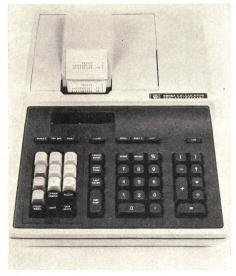
vom Drucker mit den entsprechenden Symbolen bezeichnet. Ausgedruckt werden das zehnstellige Ergebnis mit Vorzeichen und bei Gleitkomma-Darstellung der Exponent.
