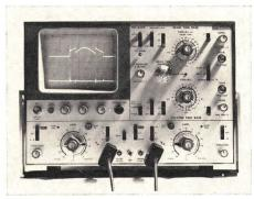
leiter-Technik: Dass man sowohl Kollektorstrom als auch Kollektorspannung eines Transistors mit einem Zweistrahl-Oszillographen gleichzeitig darstellen kann, ist nichts Neues. Diese zwei Oszillogramme können jedoch, wenn sie als Multiplikations-Oszillogramm zu sehen sind, überraschende Zusammenhänge aufzeigen. So ist es durchaus möglich, dass für kurze Zeit sehr hohe Leistungsspitzen entstehen, mit deren Existenz man nicht gerechnet hat. Damit wird ein wichtiger Vorteil deutlich:
