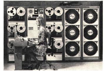
Fig. 2 Vorprogrammierbare Videoband- und Filmabspieleinheit mit Eingabeeinheit für den Programmcomputer
