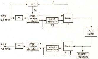
Fig. 1 Blockschaltung des adaptiven Intraframe-Codierers
