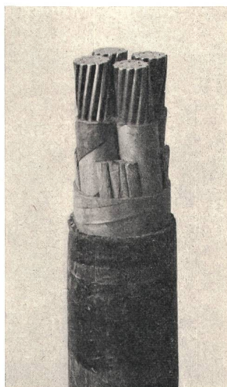
Fig. 1 Aluminiumleiterkabel aus den Jahren 1939 bis 1945
