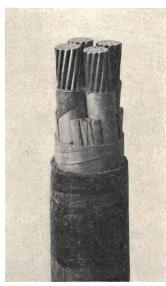
Fig. 1 Aluminiumleiterkabel aus den Jahren 1939 bis 1945
