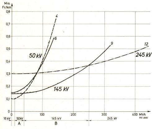
Fig. 7 Gesamtkosten von Freileitungen Wirtschaftlicher Einsatzbereich 50, 145, 245 kV
