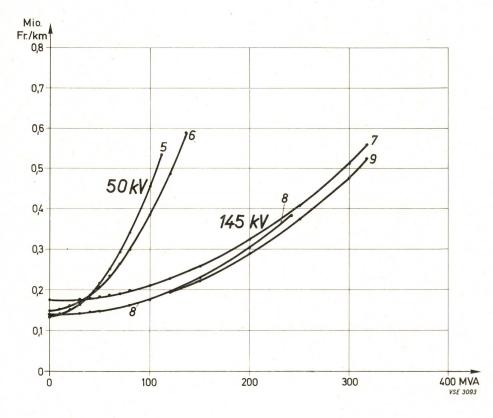
Fig. 5 Gesamtkosten von Freileitungen Betonmastleitungen 50 und 145 kV
