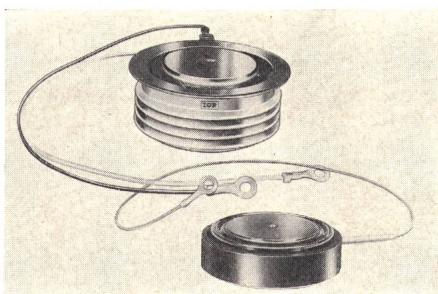
Die Keramik-Serie und die Plastik-Serie werden für Spannungen von 50...600V angeboten. Beide spezifizieren einen Spitzestrom von 8250 A und ein  $I^2t$  von 340 000 A $^2$ s.
