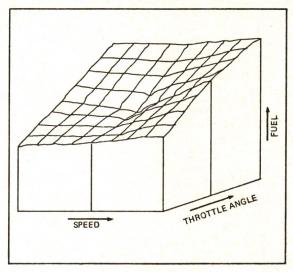
Fig. 1 Interpolierter Treibstoffverbrauch in Abhängigkeit von Motordrehzahl und Drosselklappenstellung.
