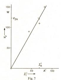
Diagramm  $V_Z = f(I_1^2)$  zur Auswertung der Messergebnisse des Normmotors Bezeichnungen siehe im Text
