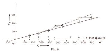
Diagramm  $\mathfrak{g}_{a}=\mathrm{f}(V_{\mathrm{H}})$  zur Auswertung der Messergebnisse des Normmotors mit 16 Läufernuten
