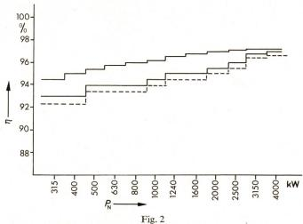
Wirkungsgrade der 4poligen durchzugbelüfteten Kurzschlussläufermotoren für Hochspannung von 6 kV
