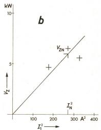
Fig. 8 Diagramme zur Auswertung der Messergebnisse des Hochspannungsmotors  $\begin{array}{ccc} a & \vartheta_{\text{Li}} = \mathrm{f}(V_{\text{H}}) \\ b & V_{\text{Z}} = \mathrm{f}(I_{1}^{2}) \end{array}$
