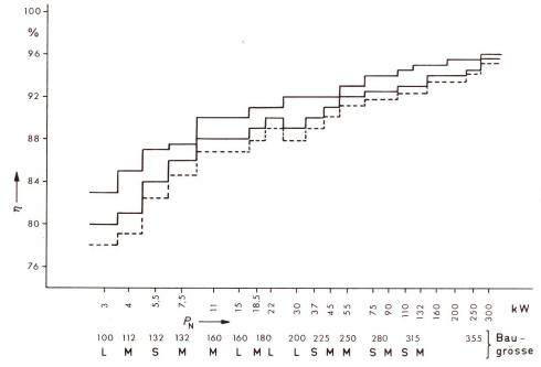
Fig. 1 Wirkungsgrade der 4poligen Norm-Kurzschlussläufermotoren der Schutzart P 33
