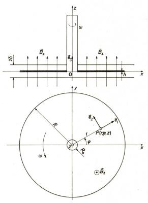
Fig. 1 Unipolarmaschine mit punktförmiger Stromabnahme
