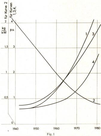
Ausnützungskennwerte von BBC-Turbogeneratoren seit 1940 Kurve 2 in kg/kW; Kurven I, 3 und 4 in p. u.
