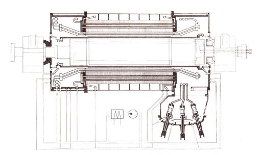
Fig. 4 Kühlschema des Generators Skaerback III mit vollständiger Wasserkühlung
