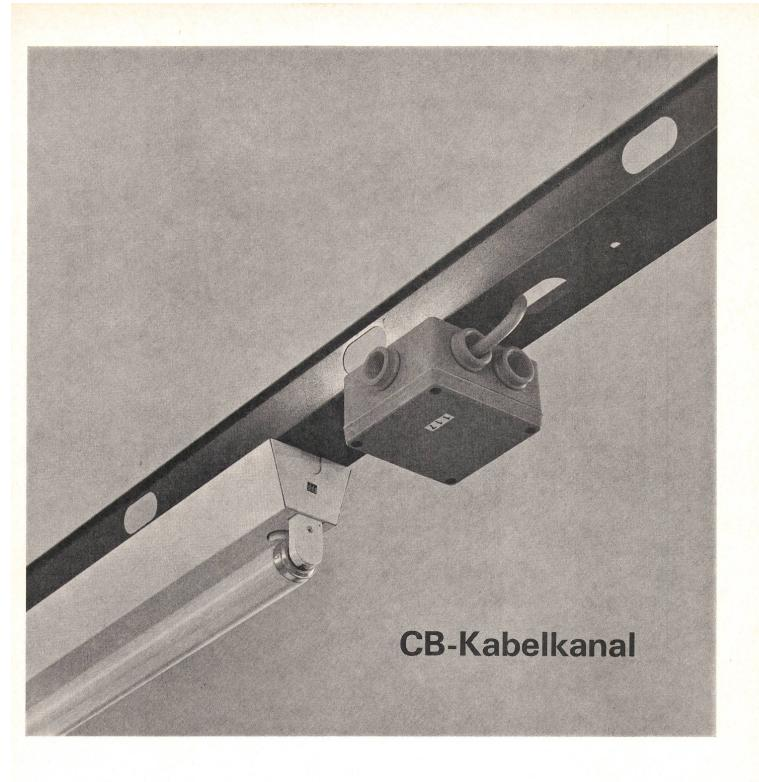
Der neue Kabelkanal, in weiss plastifiziertem Zinkorblech, 70×40 mm, schliesst eine wesentliche Marktlücke. Dank seiner einfachen Montageart ist es ein preisgünstiger Ersatz für das bisher übliche Sammelrohrsystem für Speiseund Verteilleitungen in heruntergehängten Decken. In offener Montage ist er Kabel- und zugleich Leuchtenträger. Der Boden des Kanals ist auf die Breite der normalen Fluoreszenzarmaturen ausgerichtet. Verlangen Sie unsere ausführliche Dokumentation.
