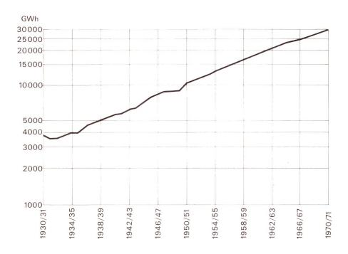
Fig. 1 Verbrauch elektrischer Energie in der Schweiz in GWh1) 1930/31-1970/71 (Jahrestotal ohne Elektrokessel und Speicherpumpen)
