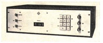
Fig. 1 Versuchsmodell eines Einseitenband-Rundfunkempfängers mit digitaler Senderwahl nach dem Rasteroszillatorprinzip
