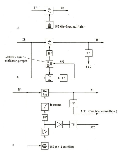
Fig. 11 Drei Verfahren zur Trägerregenerierung
