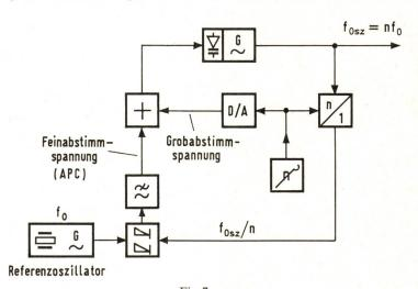
Fig. 7 Gerasterte Abstimmung des Mischoszillators durch digital einstellbaren Frequenzteiler in der Regelschleife
