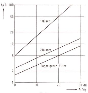
$\label{eq:Fig. 13} Fig. 13$  Tiefste zulässige Modulationsfrequenz  $f_{\rm t}$  für 5 % Klirrfaktor im Verhältnis zur 3-dB-Bandbreite B verschiedener Trägerfilter dargestellt in Abhängigkeit von der Trägerunterdrückung
