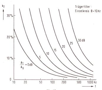
Fig. 12 Klirrfaktor tiefer Modulationsfrequenzen bei Hz-Bandbreite eines Einzelkreis-Trägerfilters
