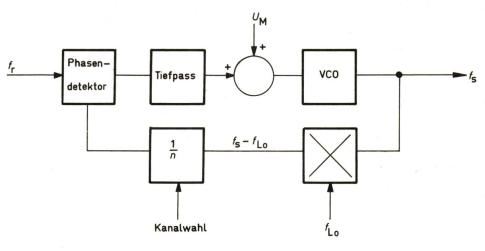
Mit der Wahl von n kann nun der HF-Kanal eingestellt werden. Sind  $f_r$  und  $f_i$  quarzstabil, und gilt weiter  $f_r$   $n \ll f_i$ , so lässt sich zeigen, dass die Frequenzstabilität von  $f_s$  vor allem von der Stabilität von  $f_i$  abhängt. Die quarzstabilen Referenzfrequenzen können mit höherem Anfangspegel erzeugt werden, als dies bei konventionellen Methoden möglich ist. Dies ist im Sinne eines grösseren Rauschabstandes erwünscht.
