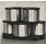
2500000 m Telefondrähte durchlaufgeglüht
