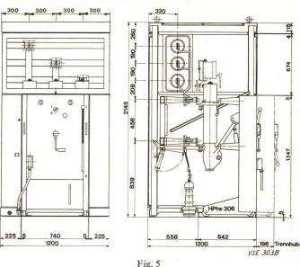
Metallumkleidete Schaltanlage, Typ PA
