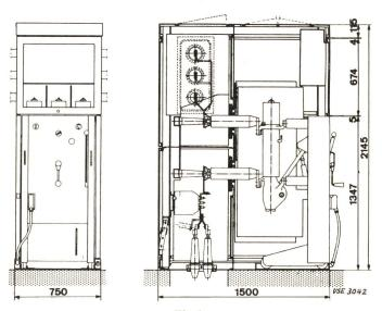
Fig. 9 **Metallgeschottete Schaltanlage, Typ PD** Zellenbreite für 12 und 24 kV 750 mm
