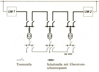
Fig. 8 Prinzipschema einer Elektrizitätsversorgung Schema II
