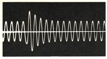
Fig. 2 Spannungsverlauf bei der Prüfung eines kV-Wandlers
