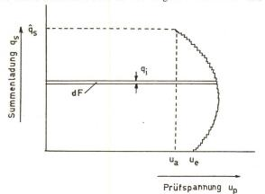
Fig. 1 Summenladung in Abhängigkeit von der Prüfspannung während einer Halbperiode  $q_{\mathrm{S}} = \mathrm{f}[u_{\mathrm{D}}(t)]$
