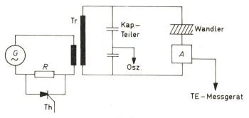
Fig. 1 Prüfschalter für Messwandler
