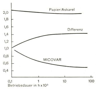
Fig. 1 Spezifische Leistungsverluste in Kondensatoren
