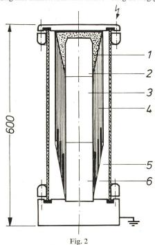
Normalkondensator 100 kV, 50 pF, 50 Hz,  $\tan \delta = 10 \cdot 10^{-5}$
