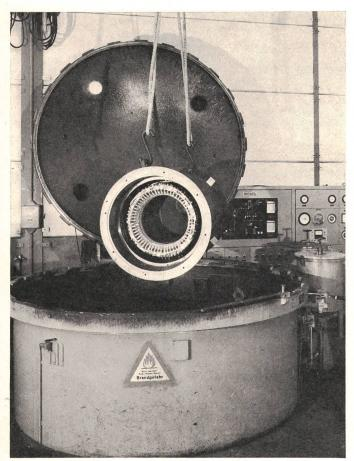
Fig. 2 Einfahren des gewickelten Ständers in das Imprägniergefäss
