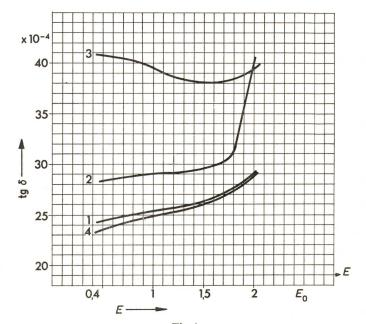
Fig. 1 1 × 300 mm<sup>2</sup> 220/127 kV Gasdruckkabel  $I \vartheta_{\rm c} = 20 \, {}^{\circ}{\rm C}$ p = 12 atü Ausgangszustand  $\theta_{\rm c} = 19 \, {}^{\circ}{\rm C}$ p =0 atü nach Stromzyklus mit  $\vartheta_c = 65$  °C  $3 \vartheta_{\rm c} = 19 \,{}^{\circ}{\rm C}$ p = 0 atü nach Stoss 1050 kV und 500 kV~  $= 18 \, {}^{\circ}\text{C}$ p = 12 atü nach 10 min Druckeinwirkung
