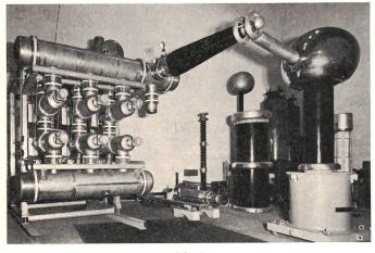
$Fig. \ 3 \\ \textbf{245-kV SF}_6\textbf{-Schaltfeld im Dauerversuch}$
