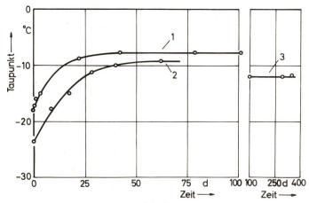
$\begin{array}{c} {\rm Fig.~1} \\ {\rm \bf Taupunktmessungen~an~SF}_6\text{-isolierten~110-kV-Schaltanlagen} \\ {\rm Erl\"{a}uterungen~siehe~im~Text} \end{array}$
