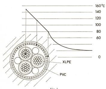
$Fig. \ 1$  Temperaturverlauf eines CEANDER-Kabels bei Verlegung in Sand
