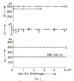
Dauerversuch- und Prüfspannungen
