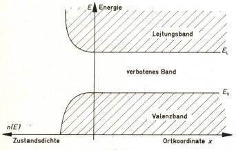
Fig. 2 Bändermodell eines idealen kristallinen Festkörpers
