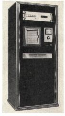
und registriert Schwerwasserverluste durch den Abstrahler bei Kernreaktoren. Er arbeitet vollständig automatisch.
