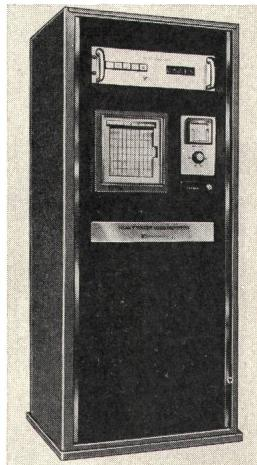
und registriert Schwerwasserverluste durch den Abstrahler bei Kernreaktoren. Er arbeitet vollständig automatisch.
