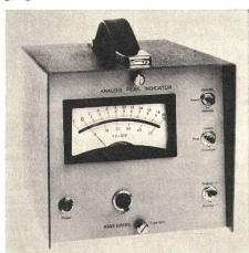
Durch Reduktion der Speicherzeitkonstanten kann das Gerät auch zur Erfassung der Hüllkurve einer Impulsreihe oder als normales Anzeigegerät eingesetzt werden.
