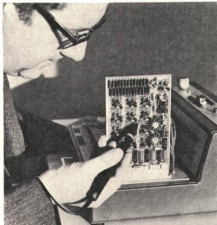
gruppe, lokalisieren. Beim Verfolgen eines fehlerhaften Signalweges innerhalb der Schaltung können damit logische Schaltzustände «O» oder «L» sowie Signalwechsel «O → L» erkannt werden. Der jeweilige Zustand wird über drei farbige Leuchtringe im Tastkopf der Prüfspitze angezeigt. Ist ein Prüfling am Logikprüfgerät adaptiert, lässt sich mit der TTL-Prüfspitze eine gezielte Fehlersuche betreiben.
