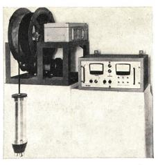
Schlamm die Lichtabsorption misst und mit einem eingestellten Sollwert vergleicht. Eine im Gerät vorhandene Nachlaufeinrichtung führt die Sonde der Trennschicht selbsttätig nach.
