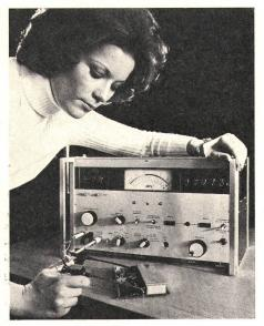
bei 10 Hz beginnt. Der im Lieferprogramm neue Analysator D 2040 ermöglicht damit auch die Untersuchung von akustischen und mechanischen Schwingungen, die unterhalb der Hörgrenze liegen.
