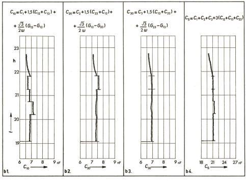
${\bf Fig.~7} \\ {\bf Registrierstreifen~der~Real-~und~Imagin\"ar-komponenten~der~Phasenadmittanz~Y_{k0}~und\\ {\bf Isolierungsadmittanz~Y_s~in~Abh\"angigkeit~von~der~Zeit} \\$
