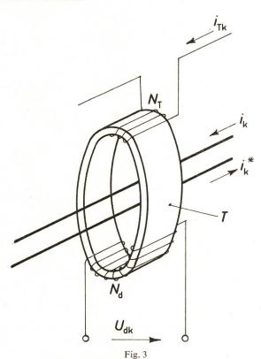
Blockschema des Stromkomparators zur Messung des Differenzstromes  $\Delta i_k = i_k * - i_k$
