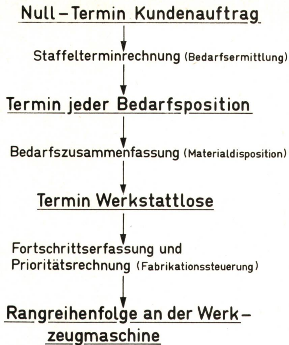
Fig. 2 Auftragsabwicklung und Terminierungsphasen
