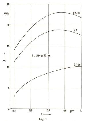
Übertragungsbandbreite einer 10 km langen Glasfaserleitung aus verschiedenen Glassorten des Jenaer Glaswerkes Schott & Gen., Mainz
