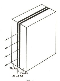
Fig. 6 **Aufbau einer Doppelheterostruktur eines GaAs-Halbleiterlasers**
