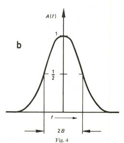
Verzerrung einer Einschaltfunktion in einer Multimode-Glasfaserleitung
