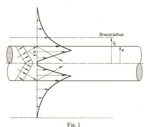
Entstehen der Feldverteilung in einer dielektrischen Oberflächenwellenleitung
