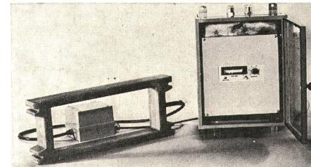
Spannungsabsenkung wird von einem Niemannskriminator erfasst, dessen Ausgangssignal verstärkt und auf die Erregerspule des Ausgangsrelais gegeben wird. Über die Schaltkontakte des Relais kann dann eine optische oder akustische Meldung ausgelöst oder das betreffende Förderband automatisch stillgesetzt werden.
