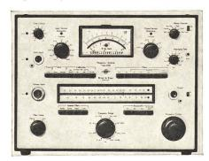
Schwingungen im Frequenzbereich von 2 Hz...20 kHz. In Verbindung mit Kondensator-Messmikrophonen und Schwingungsaufnehmern wird der Analysator ein Präzi-
