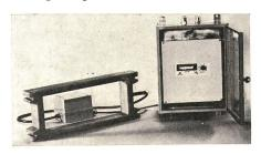
Spannungsabsenkung wird von einem Niveaudiskriminator erfasst, dessen Ausgangssignal verstärkt und auf die Erregerspule des Ausgangsrelais gegeben wird. Über die Schaltkontakte des Relais kann dann eine optische oder akustische Meldung ausgelöst oder das betreffende Förderband automatisch stillgesetzt werden.
