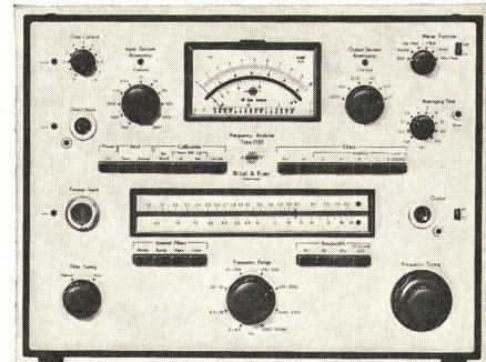
Schwingungen im Frequenzbereich von 2 Hz...20 kHz. In Verbindung mit Kondensator-Messmikrofonen und Schwingungsaufnehmern wird der Analysator ein Präzisions-Schallpegelmesser beziehungsweise Schwingungsmessgerät entsprechend internationalen Normen.
