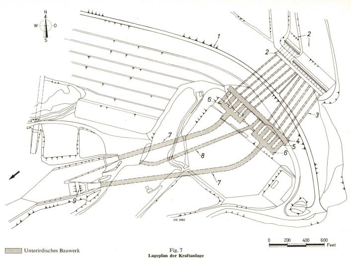
1 Dammkrone, 2 Einlaufbauwerk, 3 Druckstollen (5,5 m  $\phi$  × 210 und 240 m), 4 Maschinenhaus (270 × 20 × 47 m), 5 Turbinenauslass, 6 Sammelkammer, 7 Ablasstunnel (14,6 × 20 m, 290 und 490 m), 8 Zugangstunnel, 9 Fangdamm
