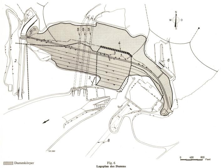
1 Dammkrone, 2 Überfallrinne, 3 Drainagetunnel, 4 Zementabdichtung, 5 Grundablass, 6 Einlaufbauwerk, 7 Schaltanlage, 8 Fernleitungen
