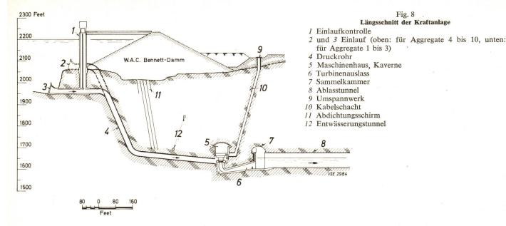
der Sektion sind Plätze für fünf 227-MW-Turboaggregate vorhanden, wobei jede Turbine von einem besonderen Druckrohr gespeist wird. Zwei Abwassertunnels leiten das Wasser ins Flussbett zurück. Die Francis-Turbinen sind für eine Fallhöhe von 150 m und eine Leistung von 227...260 MW ausgelegt worden (Fig. 9). Die Laufräder der elektrischen Generatoren, bei einem Durchmesser von 10,9 m, haben ein Gewicht von 44 t; zu ihrem Einbau müssen die beiden 310-t-Brückenkrane benutzt werden.
