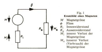
Bei einer Spule ist die konstante Grösse – die Quellgrösse – durch den Strom I und die Anzahl der Windungen N also durch das Produkt NI gegeben. Eine ähnliche Möglichkeit bieten die Ampèreschen Molekularströme, deren Summe eine entsprechende Grösse darstellt.
