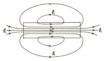
Fig. 6 Aufteilung des Magnetflusses in Hauptfluss  $m{\varPhi}_{\rm h}$  und Streufluss  $m{\varPhi}_{\rm s}$
