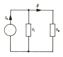
$\begin{array}{ccc} & \text{Fig. 2} \\ \textbf{Duales} & \textbf{Ersatzbild} \\ I_{k} & \text{Magnetgrösse} \\ G_{i}, & G_{a} & \text{Innen- und} \\ \text{Aussenleitwert} \end{array}$
