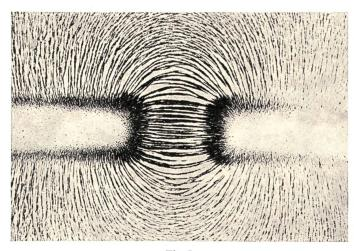
Fig. 5 Annähernd homogener Fluss zwischen zwei Magneten
